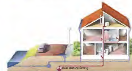
Principe gescheiden rioolstelsel
