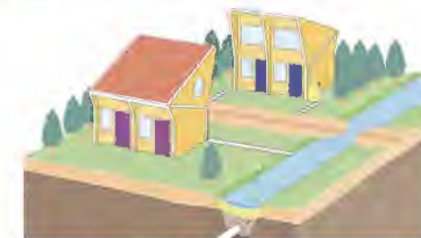
Principe gescheiden rioolstelsel met berging
